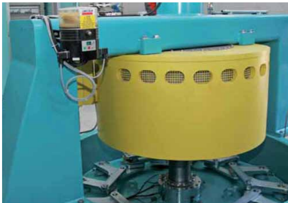
Kompakt bedienerfreundlich: Neu entwickelter Wasserkraft-Permanentgenerator der Firma WATEC-Hydro.
